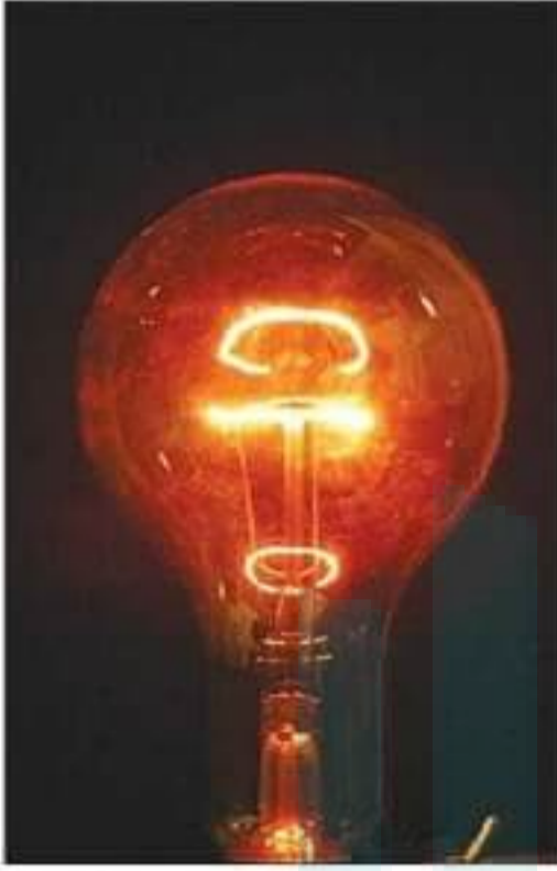
الشكل ١٤ يستخدم العنصر الانتقالي التنجستون في مصابيح الإنارة بسبب ارتفاع درجة انصهاره.
