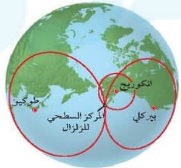
الشكل ٦ بعد حساب المسافة من ثلاث محطات رصد على الأقل يتم رسمها على الخريطة في صورة دوائر ذات أنصاف أقطار تساوي بُعد الزلازل عن المحطة. يكون المركز السطحي للزلازل هو مكان التقاء الدوائر الثلاث.
